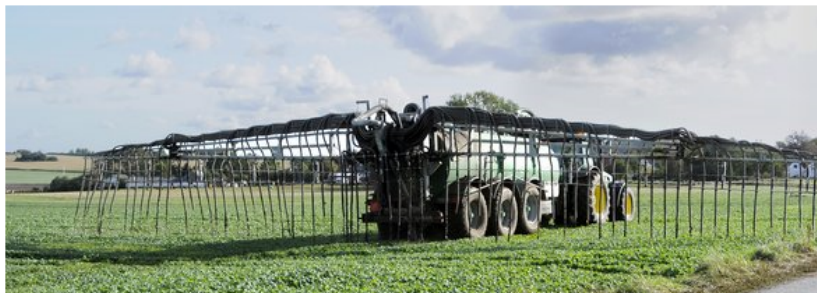
Ammoniakdampe fra husdyrgødning er en af de største kilder til luftforurening herhjemme. Næringsstofferne skader omkringliggende natur. Derfor forsøger landmændene at begrænse afdampningen ved bl.a. at hælde gyllen på mar gennem slanger. Foto: Colourbox
